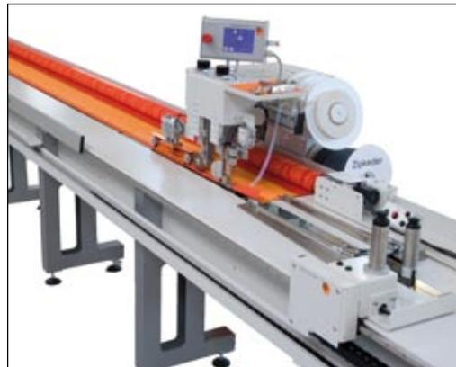
Mit der Ultraschall-Schweißanlage können unterschiedliche Stoffe konfektioniert werden.
