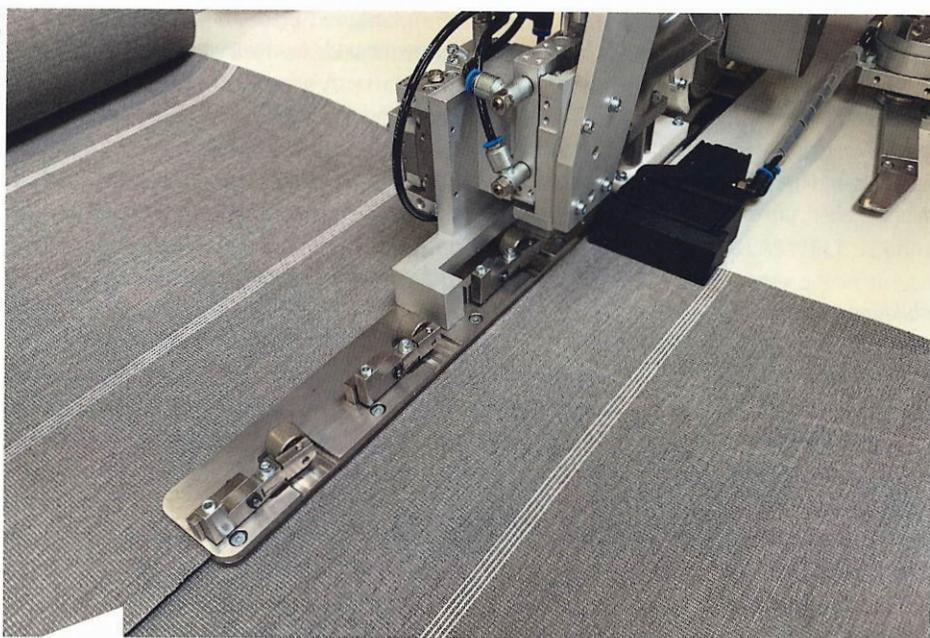
Mit einem Führungsautomaten werden die Gewebebahnen für die Stoßnaht zusammengeführt und mit einem speziellen Klebeband verklebt. Die Jentschmann-Anlage kann Stoßnähte und Überlappungsnähte verarbeiten.
