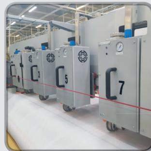
Bis zu 11 Schweisseinheiten können eingesetzt werden. Der Nahtabstand bei 11 Einheiten beträgt 9 Zoll (22,86 cm).
